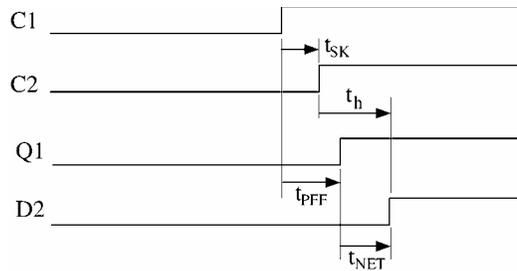
$$t_{SK} + t_h \leq t_{PFF} + t_{NET}$$
