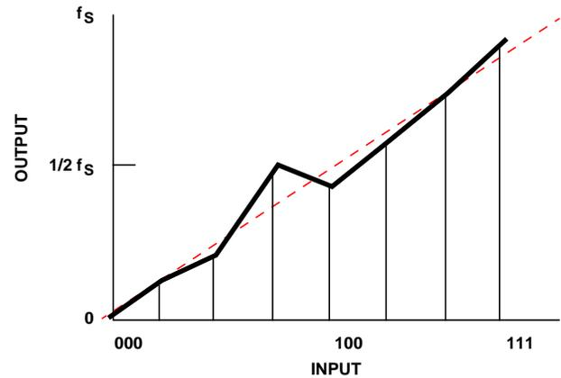
FIGURE 42A. NONMONOTONIC D/A CONVERTER
