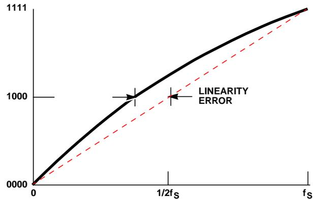
FIGURE 40C. LINEARITY ERRORS FOR AN A/D CONVERTER
