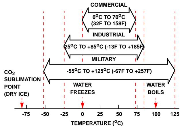
FIGURE 44. STANDARD OPERATING TEMPERATURE RANGES FOR DATA CONVERTERS
