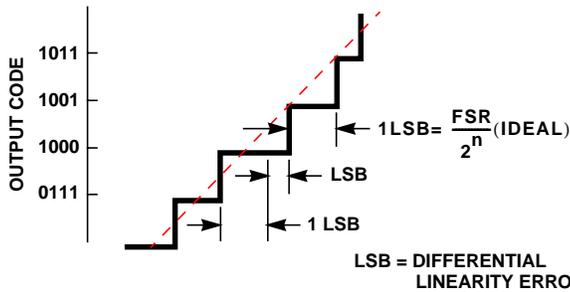
FIGURE 41. DEFINING DIFFERENTIAL LINEARITY ERROR
