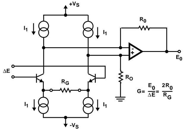
FIGURE 11. SIMPLIFIED INSTRUMENTATION AMPLIFIER CIRCUIT
