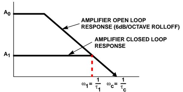
FIGURE 14. AMPLIFIER SINGLE-POLE OPEN LOOP GAIN CHARACTERISTIC
