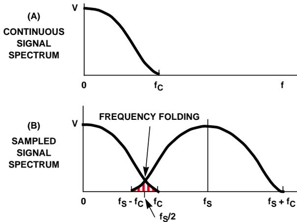
FIGURE 7. FREQUENCY SPECTRA DEMONSTRATING THE SAMPLING THEOREM
