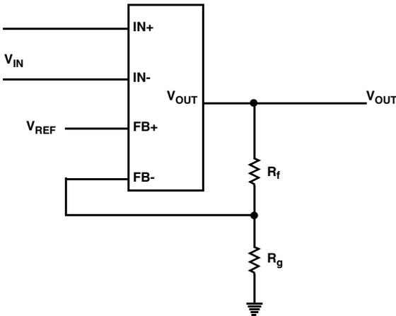
FIGURE 20. BASIC CIRCUIT
