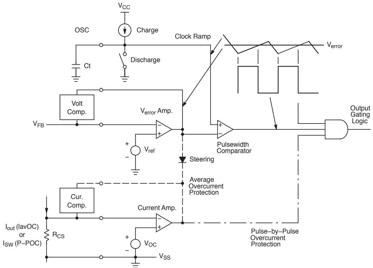
Figure 14. Voltage-Mode Control
