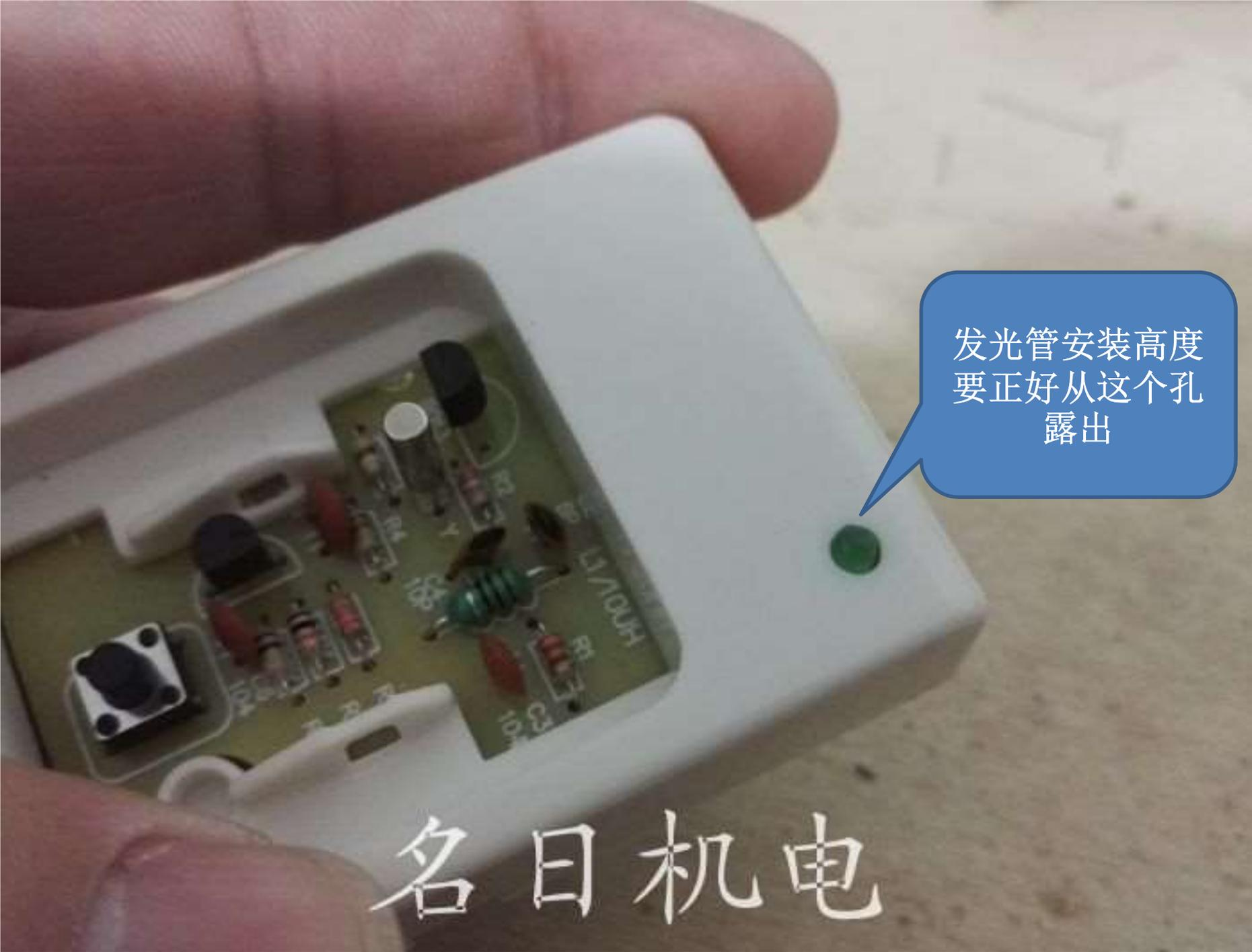
发光管安装高度
